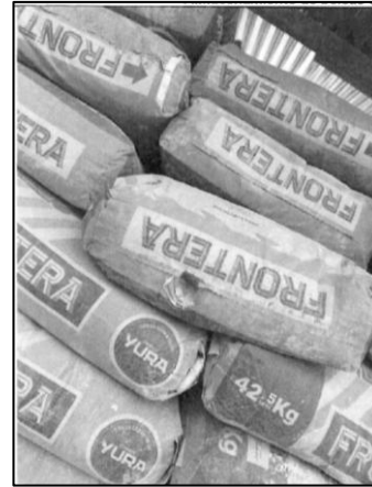
Imagen N° 83: Bolsa de cemento que presenta deterioro en su empaque
